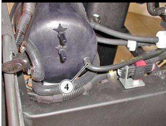
● 断开从真空罐通向执行器控制电磁阀的管**(4)**。
