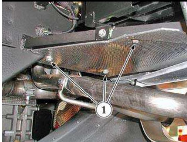
● 松开三个紧固螺钉(1)并拆卸左侧隔热罩。
