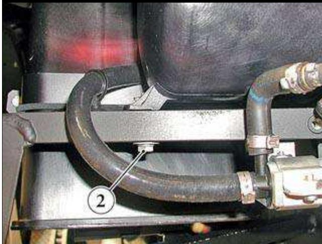
■ 拧紧紧固真空罐的螺钉(2)。
