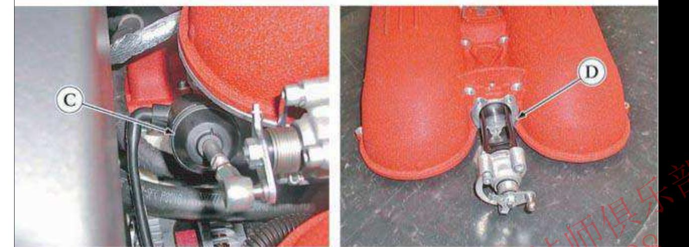
发动机ECU控制驱动进气歧管前部执行器(C)的电磁阀。
