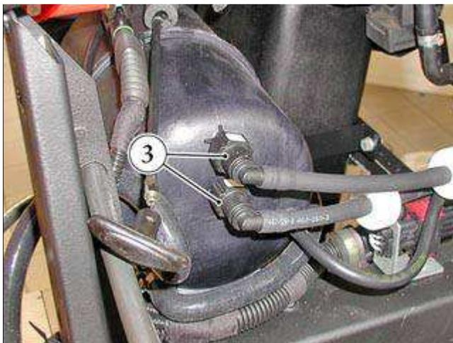
■ 将真空罐连接至进气歧管的两根管上的两个快速接头(3)。
