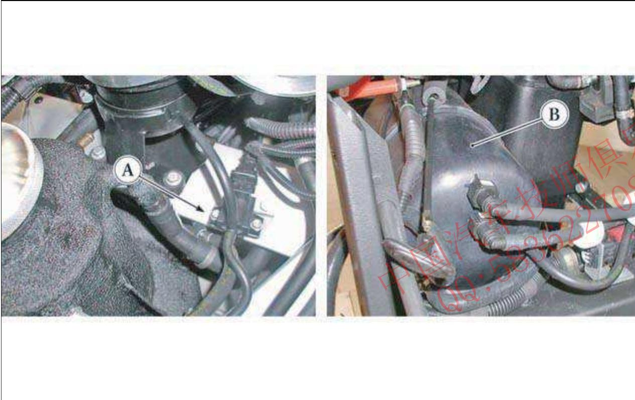
该系统包括一个紧固至变速箱副支架支撑横梁的电磁阀(A)，并连接至位于左后保险杠下方的真空贮存罐(B)。
