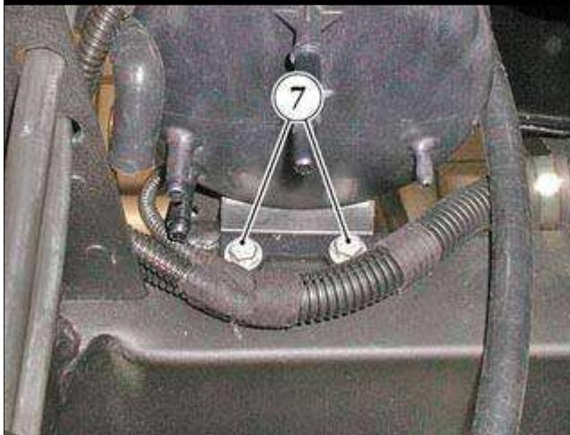
● 要重新装配, 将真空罐安装在其相应底座中并通过拧紧两个紧固螺钉**(7)**固定。
