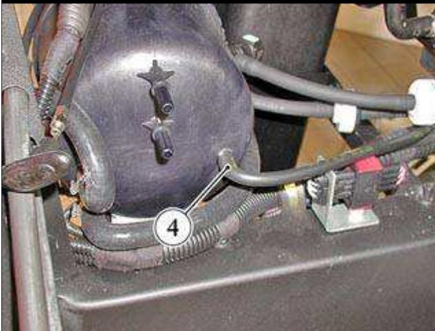
■ 将通向执行器控制电磁阀的管(4)连接至真空罐。
